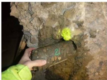
Vývrt číslo 2 byl provedený do čela střední zdi.
